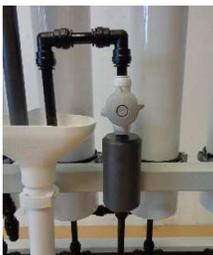
7. Abra la válvula de cierre vías que permeado al desagüe.
