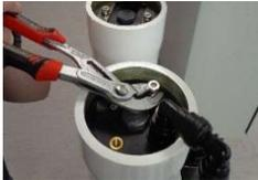
3. Levante la tapa del módulo con un alicate.
