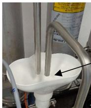
5. Am Permeatablauf mit Teststreifen auf richtige Desinfektionsmittelkonzentration prüfen. Hierzu Minncare Teststreifen Indication 1% benutzen.
