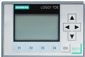
Pfeiltaste nach unten und anschließend die ESC Taste drücken. (Service Mode)
