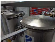
2. Moduldeckel mit Hilfe eines Schraubendrehers anheben.
