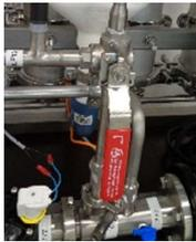
2. Ouvrez la vanne à trois voies perméat vers le drain.
