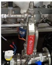
7. Fermer la vanne à trois voies perméat vers le drain.
