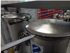
3. Soulevez le couvercle du module à l'aide d'un tournevis.
