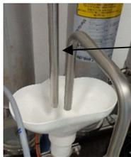
5. Vérifiez la concentration correcte de désinfectant à la sortie du perméat avec des bandelettes de test. Utilisez pour cela l'indication des bandelettes de test Minncare 1%.
