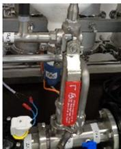
10. Ouvrez la vanne à trois voies perméat vers le drain.
